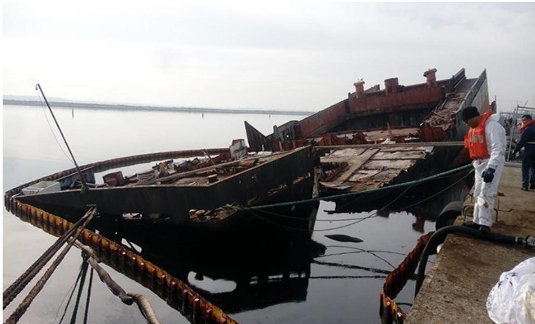
**07 Giugno 2019 - Ravenna -** “Abbiamo redatto un primo progetto operativo che prevede il sezionamento della nave in più pezzi, il loro recupero con un mezzo di sollevamento e la loro posa in banchina dove verranno effettuate le operazioni di demolizione e il successivo smaltimento”, così Daniele Rossi, presidente dell’AdSP ravennate, ha aperto la conferenza stampa tenutasi oggi per gli aggiornamenti sul recupero del relitto della Berkan B.
